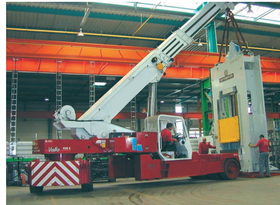
Elektrische Kranen: IMMS beschikt over een vloot van Valla-kranen: 3 ton, 7 ton, 11 ton, 20 ton, 25 ton, 40 ton en 90 ton
